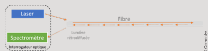
Figure 1 : configuration standard d'un système de capteur à fibre optique.
